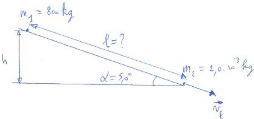
La voiture descend la pente sans frottements donc conservation de l'énergie mécanique lors de la descente. La voiture arrive au bas de la pente avec une vitesse  $v_1$  donnée par :
