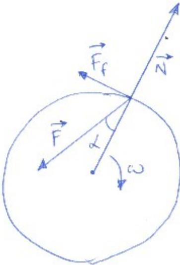
La force de frottement est tangentielle à la surface de contact ; c'est elle qui freine la rotation. Le moment de la force de frottement par rapport au centre O de la meule est, en norme :
