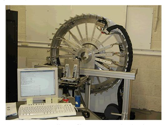
Prototype van een PET scanner voor kleine proefdieren ontworpen en gebouwd aan de VUB in samenwerking met Forschungszentrum Jülich.
