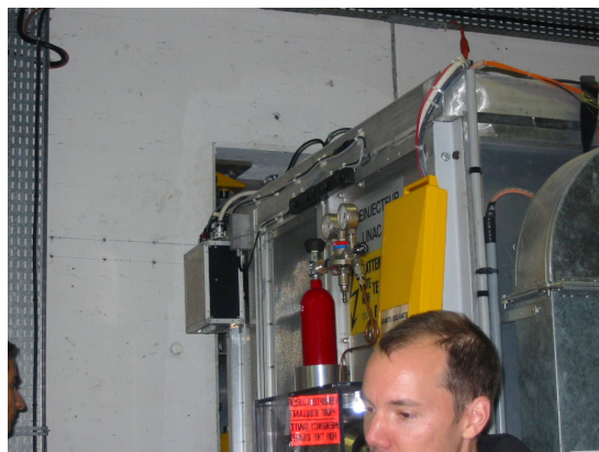
Figuur 1.5: H_2 "fles" (rood) voor proton-productie
