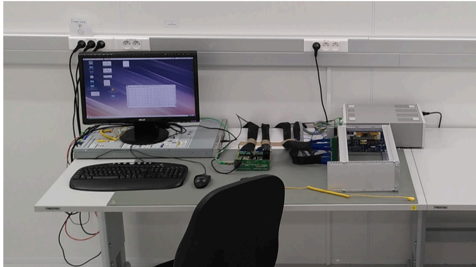
Opstelling voor het testen van de uitleesfunctionaliteit van de elektronica en de detectormodule.
