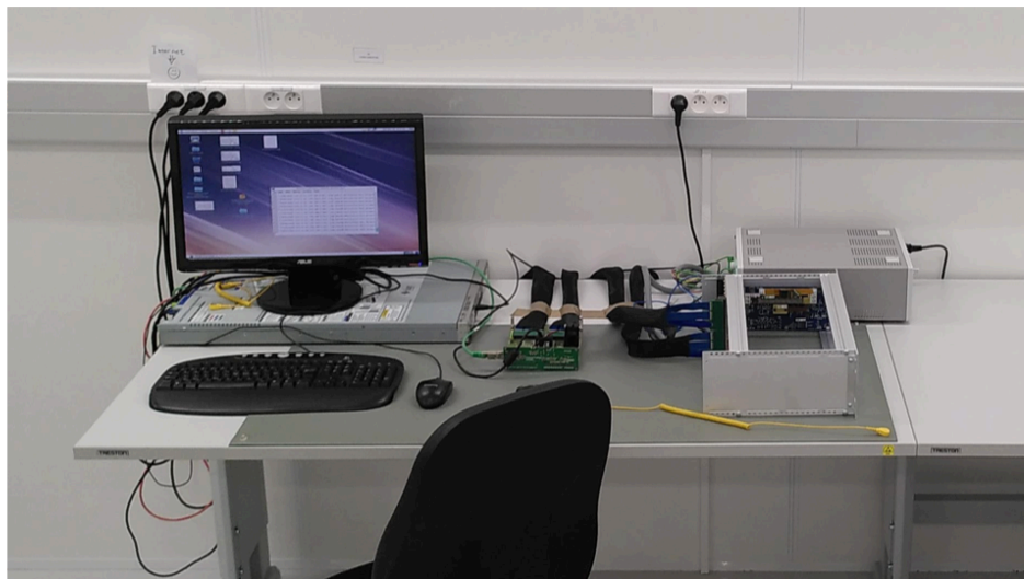
Opstelling voor het testen van de uitleesfunctionaliteit van de elektronica en de detectormodule.
