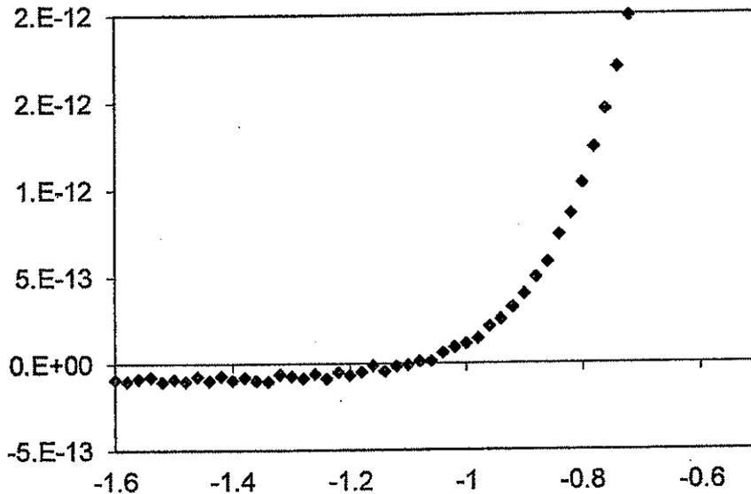
Exemple de courbe obtenue (ordonnées : courant en A, abscisses : potentiel exprimé en Volts, le signe signalant qu'il agit à l'opposé du flux normal des électrons).
