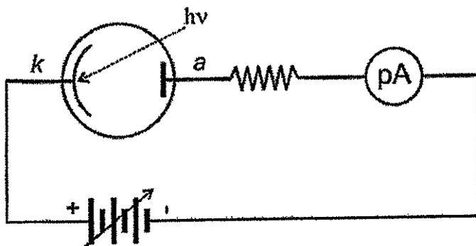
Schéma du montage. (Noter que la polarisation cathode-anode sera opposée à celle normale du fonctionnement d'une diode photo-électrique).
